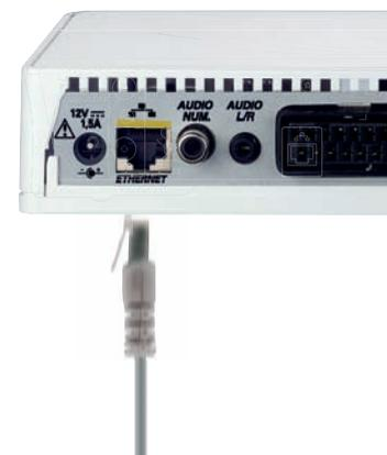
**Raccordez le décodeur à la livebox avec le câble Ethernet :**
