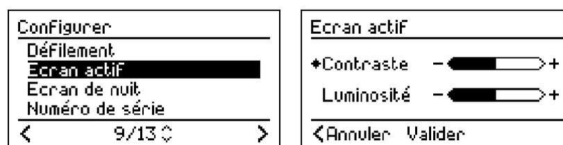
Le réglage du contraste et de la luminosité s'effectue en tournant le bouton du volume (4) pour augmenter ou réduire l'intensité.
